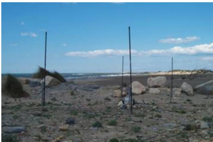
Photo3: Le réseau rectangulaire d'antennes d'émission HF (Salins de Giraud).
